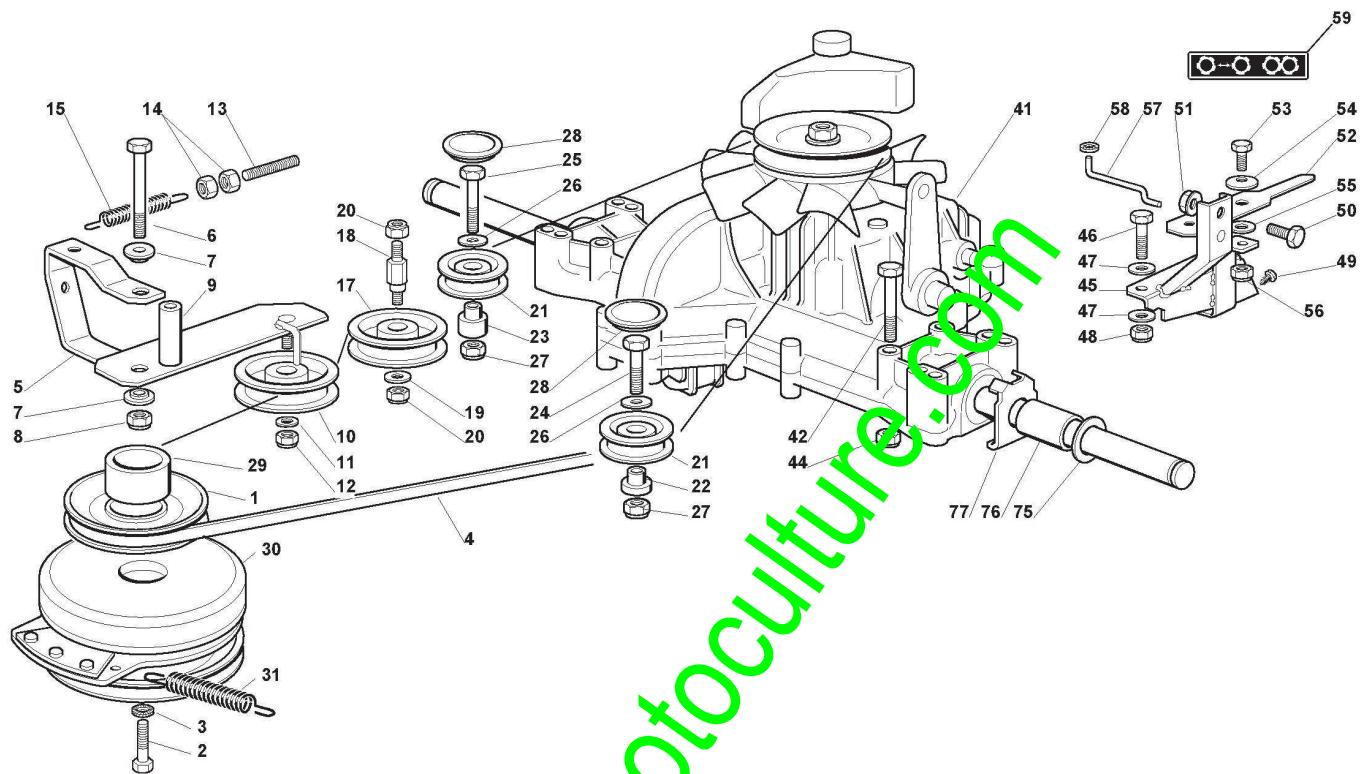
Transmission TT avec Embrayage Electromagnétique Warner
