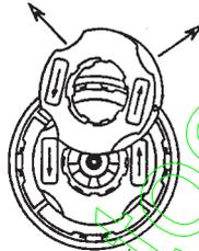
5 Retournez la bobine et enroulez les fils dans la direction indiquée par les flèches
