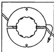
7 Remplacez la bobine à l'intérieur du carter supérieur et faites passer les fils par les œillets. Une fois cela fait, tirez sur les fils afin de les libérer des encoches.
