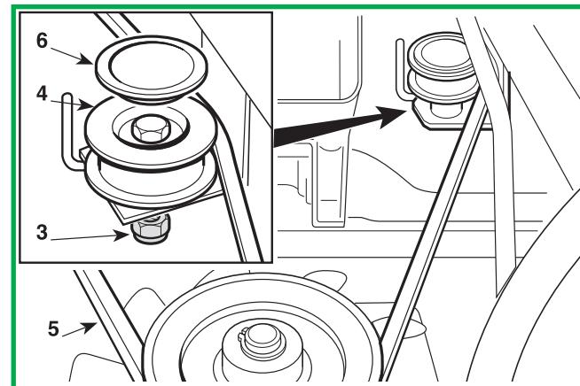
Lors du montage, veiller à remettre la courroie (5) en position exacte par rapport aux poulies, aux galets tendeurs latéraux et au guidage de retenue.
